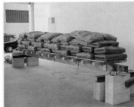
Foto 3 - La trave durante la prova di carico, realizzata con sacchi di cemento.
