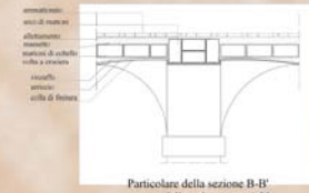
Particolare della sezione B-B' attacco delle volte rapp. 1:20
